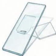
شیشه نمونه (شیشه پایه و شیشه پوششی)
